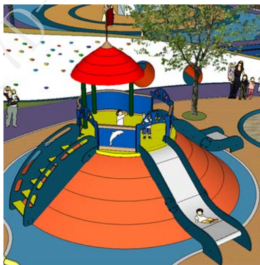
(7) 儿童滑梯：塑胶平台 R=3.5m, H=1.73m, 平台上高度=2.5m, 工程塑料+不锈钢。
