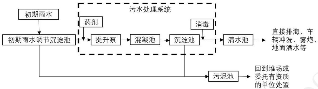
码头区域的初期雨水经管渠流至集水池，待收集池满池后，后续清洁雨水经切换管渠闸门或者溢流等方式排至水体，收集池中的初期雨水经泵提升至初期雨水处理区域，进入调节沉淀池后，大颗粒首先沉降下来，上清液进入絮凝沉淀池，在沉淀池加入絮凝剂，絮凝过程是以微粒作核心在其表面上进行的，而使微粒表面相接触，并黏结成较大颗粒，进有利于悬浮物的沉淀，随后污水进入沉淀池，将大颗粒悬浮物沉淀，沉淀后的上清液流经过滤消毒至回用水池，回用水部分可用于煤堆料的喷洒去尘，也可直接排至水体。
