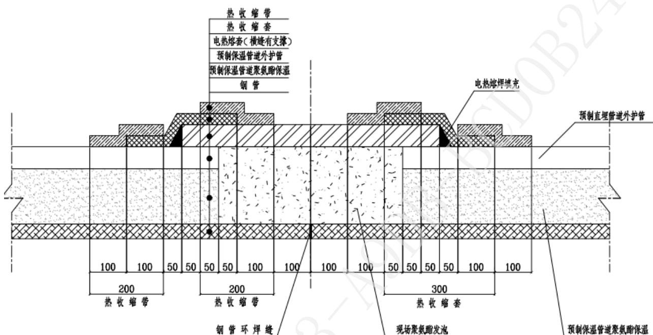
现场发泡料与直管道的发泡料必须一致，发泡时的 PE 封堵：采用 PE 塞焊分别封住发泡孔及放气孔。注意 PE 焊塞一定充分熔焊，焊接牢固。
